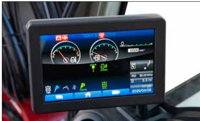
Neues 8" Multifunktions-Farb-Touch-Display: Werkstattemenü mit neuen Funktionen, automatische Einblendung der Rückfahrkamera, kratzfest, anlaufresistent.
