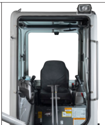
Ochranná stříška nebo kabina s ochranou ROPS, TOPS, OPG (úroveň 1) a komfortní sedadlo (voděodolná úprava) s bezpečnostním pásem.
