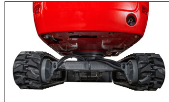
Vysoká světlá výška, uzavřený a obzvláště chránění podvozek.
