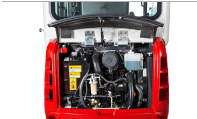
Úsporný motor s nízkou hladinou hluku a emisí s dvojitým vzduchovým filtrem a výborně přístupným motorovým prostorem.
