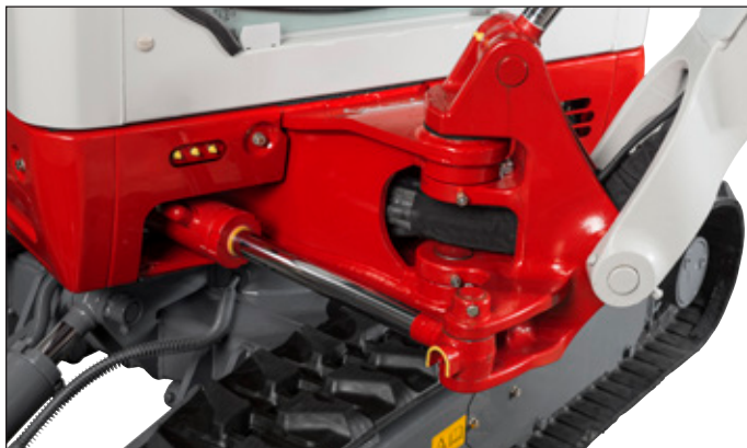
Robustní otočný kozlík se speciálně ochrannými hadicemi i hydraulickým posuvem.
