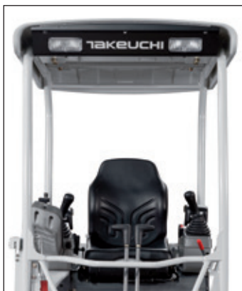
Ochranná stříška nebo kabina s ochranou ROPS, TOPS, OPG (úroveň 1) a komfortní sedadlo (voděodolná úprava) s bezpečnostním pásem.
